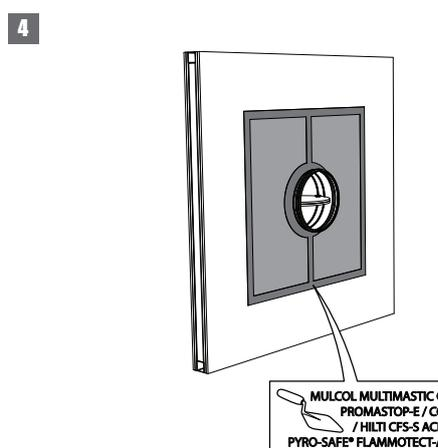
3. Les 2 couches sont posées à joints décalés et ces joints sont recouverts sur tout le contour du panneau d'enduit de type PROMASTOP-E / PROMASTOP-CC / HILTI CFS-S-ACR / Mulcol Multimastic SP / PYRO-SAFE® FLAMMOTECT-A.
